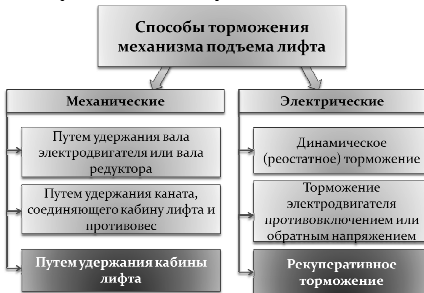
Рисунок 1. Классификация способов торможения механизма подъема лифта.
