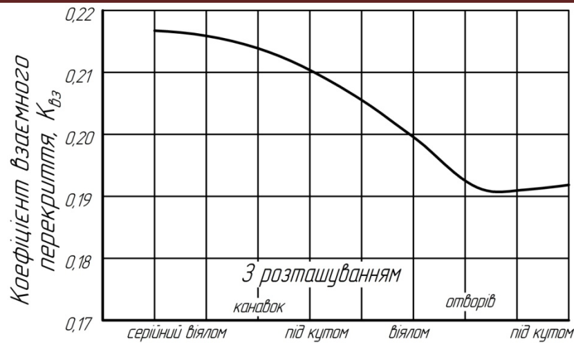
Рисунок 5 – Закономірність зміни коефіцієнта взаємного перекриття пар тертя гальма від конструктивного виконання само вентильованого гальмівного диска з елементами охолодження
