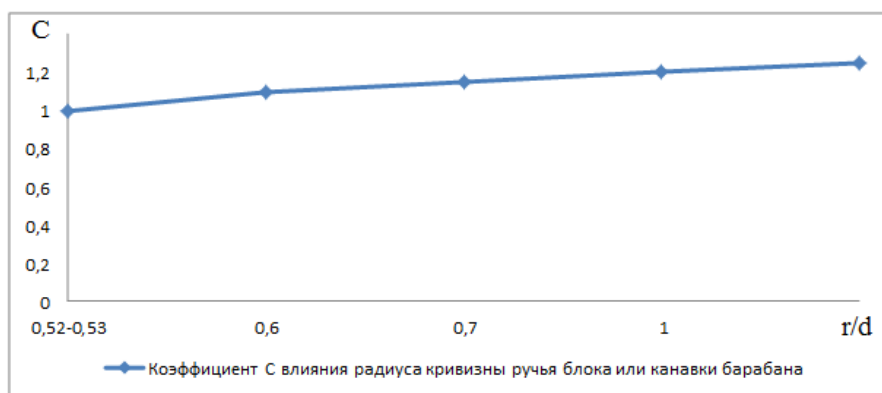
Рис 3 – Коефіцієнт C враховує вплив радіуса кривизни рівчача блоку або канавки барабану.
