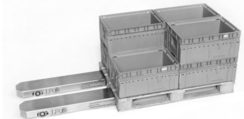
Рисунок - 1. Переміщення палет за допомогою подвійних полозів
