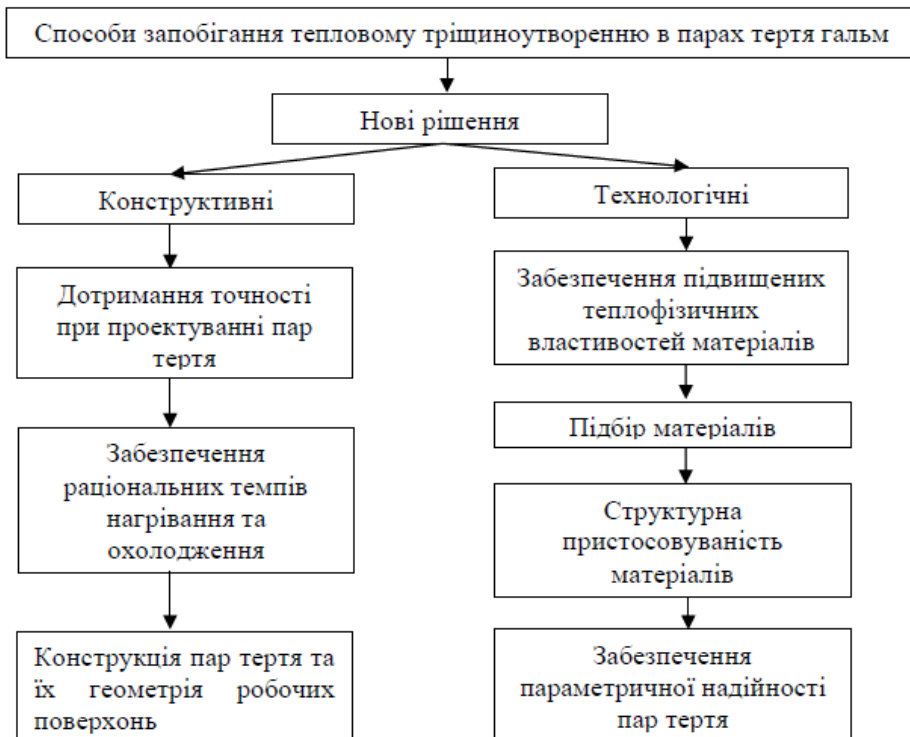
Рисунок 4 - Способи підвищення працездатності для запобігання тріщиноутворенню в парах тертя гальм
