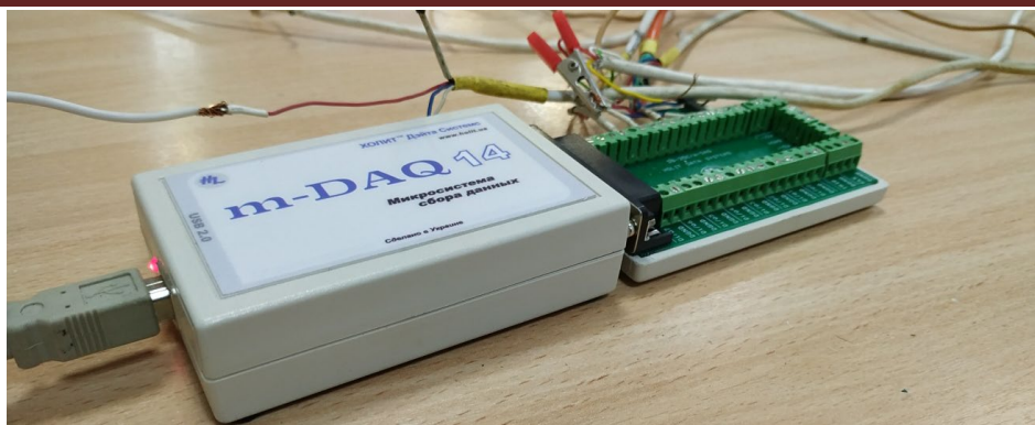
Рисунок 5 – Зовнішній вигляд пристрою збору даних m-DAQ 14 із платою, до якої підключені всі датчики
