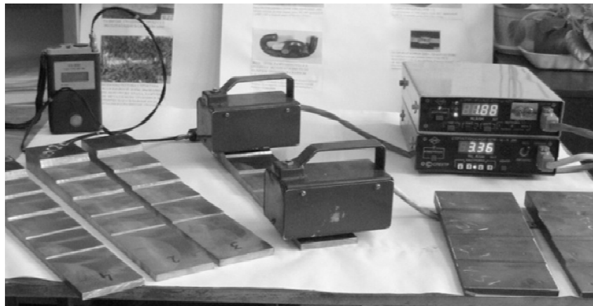
Фото 1 – Паспортизовані зразки металу із змінним перерізом
