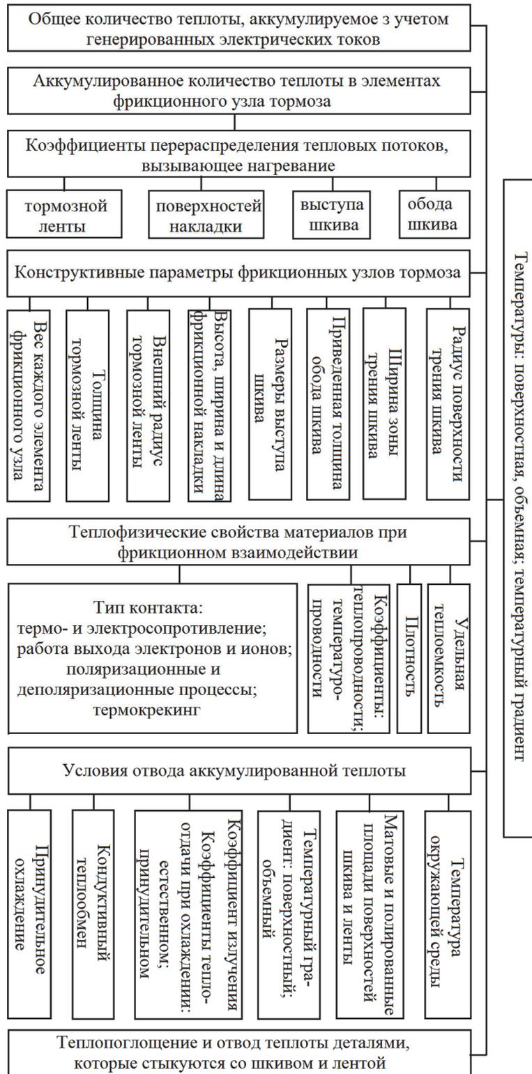
Рисунок 2 – Факторы, влияющие на тепловое состояние фрикционных узлов ленточно-колодочного тормоза
