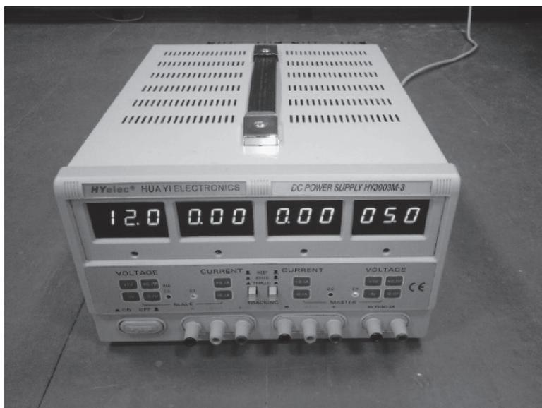
Рисунок 7 – Стабілізований блок живлення Hyelec HUA YI ELECTRONICS DC POWER SUPPLY HY3003M-3
