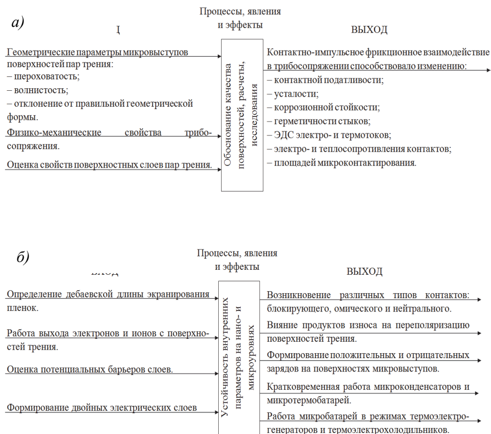
Рисунок 4 а, б – Первый и второй уровни (нано и микро) робастической методологии, касающейся: а – качества поверхностей трибосопряжения; б – устойчивостью внутренних параметров поверхностных и приповерхностных слоев трибосопряжения
