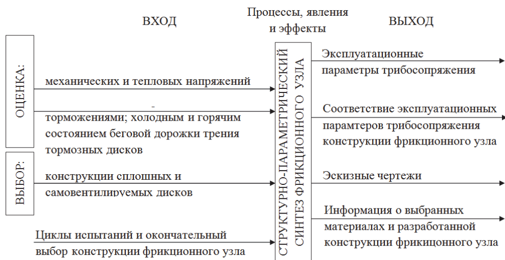
Рисунок 3 – Робастическая методология оценки структурно-параметрического синтеза фрикционного узла
