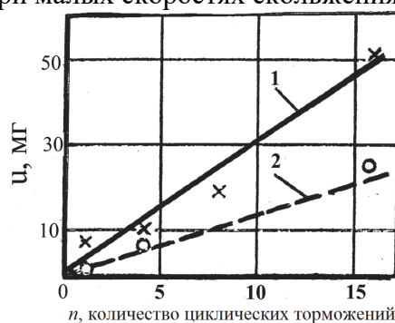
Рисунок 2 – Массоперенос материала между фрикционными накладками и рабочей поверхностью обода тормозного барабана при поляризации накладок: 1 – анодной; 2 - катодной
