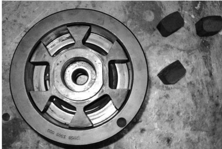
Рисунок 1 - Загальний вид фрикційної муфти (фрикційні колодки демонтовані)
