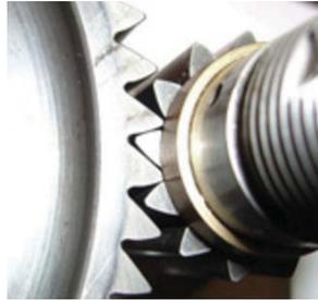
Рис.1. Передача з несиметричними зубцями
