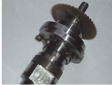
Рис.8. Дискосва фреза, встановлена зі зміщенням в радіальному напрямку для нарізання коліс за радіально-коловим способом
