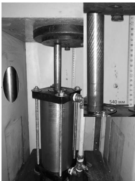
Рисунок – 2. Пружинно-гидравлический тормоз в расторможенном состоянии.
