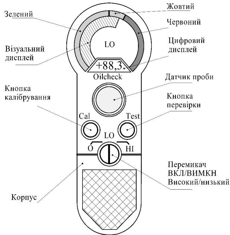
Рисунок 5 - Переносний монітор (індикатор) стану оливи моделі Oilcheck фірми «Parker»
