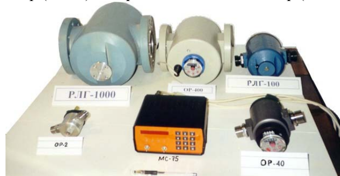
Рисунок 3 - Роликолопатеві витратоміри серій ОР-V 0 і РЛГ-V 0 та вторинний електронний прилад моделі МС-75
